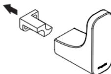
3. Coloque el ancla en la pared, nivele y marque los barrenos.
