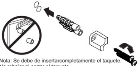
Nota: Se debe de insertar completamente el taquete. No rebajar ni cortar el taquete.
