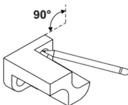
4. Barrene con broca para concreto de Ø 1/4".
