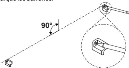
14. Barrene con broca para concreto de  $\varnothing 1/4"$ .
