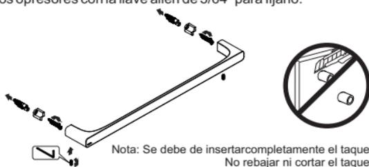
Nota: Se debe de insertar completamente el taquete. No rebajar ni cortar el taquete.
