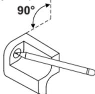
9. Barrene con broca para concreto de  $\varnothing 1/4"$ .
